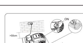
4. Installez la station de charge avec les clous et introduisez le câble d'alimentation dans la station de charge. Mettez la touche ON/OFF sur marche, puis placez la tondeuse sur la station de charge pour la charger.
