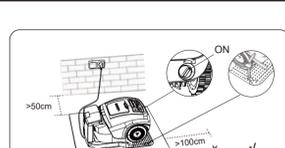
4. Installare la stazione di ricarica con i chiodi e far passare il cavo di alimentazione nella stazione di ricarica. Spostare l'interruttore ON/OFF su ON, quindi posizionare il tagliaerba sulla stazione di ricarica.
