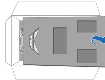
4. Placez votre main droite sous le pare-chocs de la machine, soulevez délicatement le corps de la machine et déplacez-le légèrement vers la droite. Lorsqu'il y a suffisamment d'espace à l'arrière du corps, passez votre main gauche sous l'arrière et soulevez la machine.
